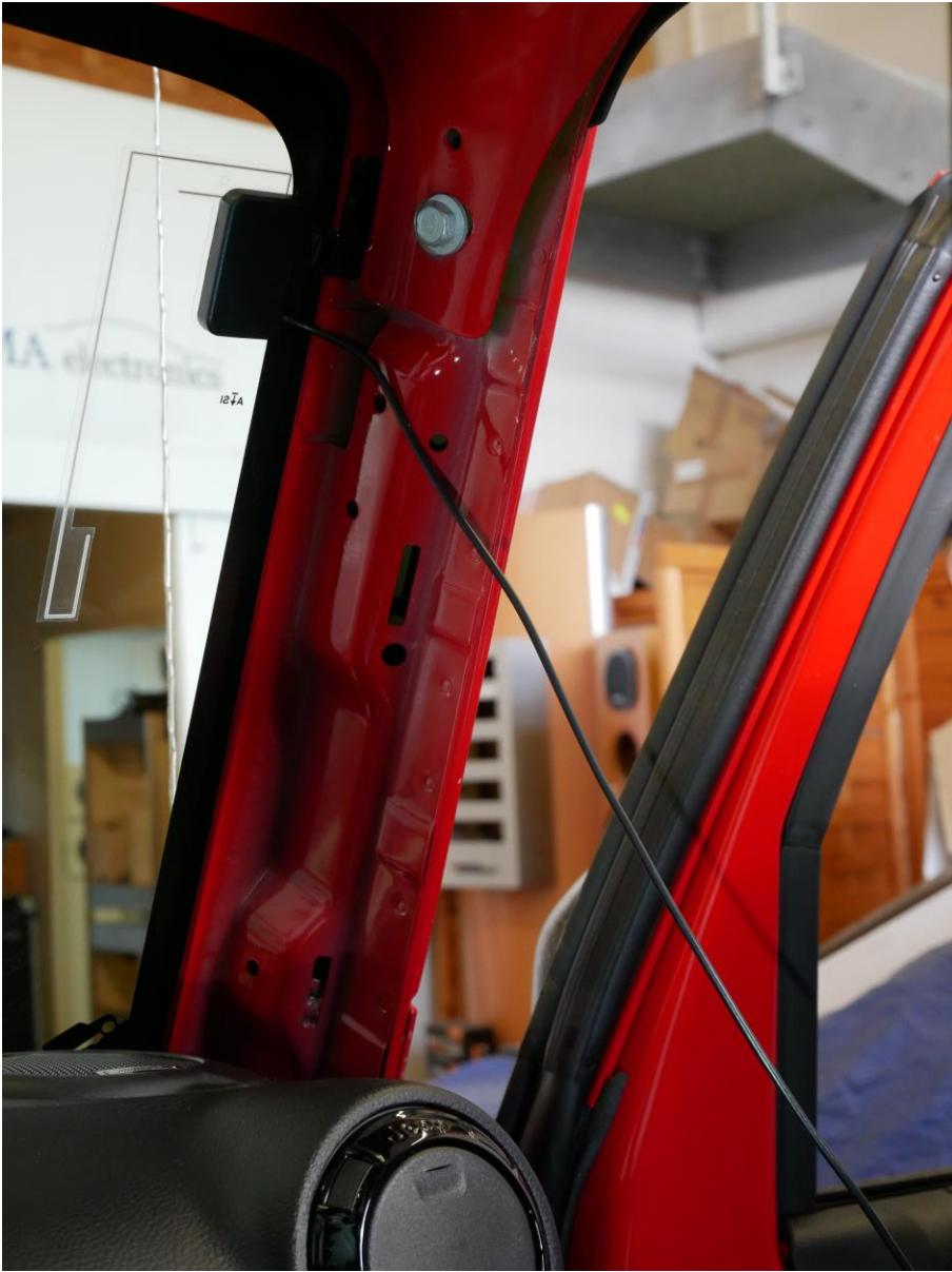
Smontare plastica piantone DX per applicare antenna DAB sul parabrezza
